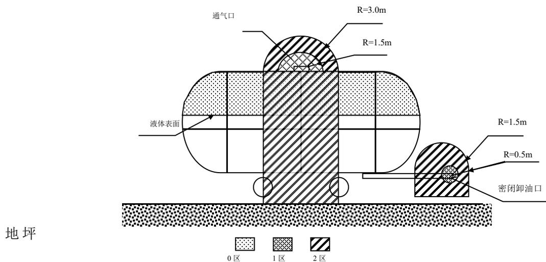
图 3.5-3 油罐车卸汽油时危险区域分布图
