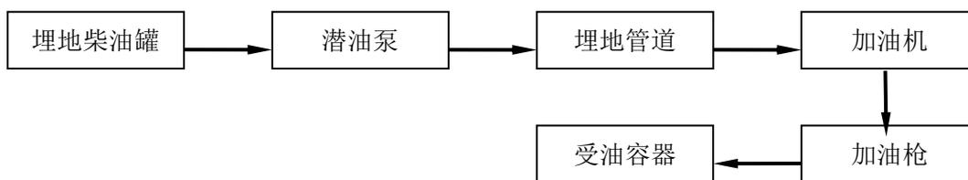
图 2.6-4 柴油加油工艺流程图示意简图
